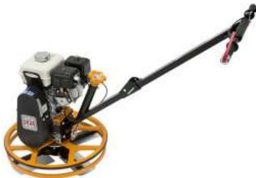
Затирочная машина TIFON 601 имеет диаметр затирочных дисков 60 см. Машины этих моделей оборудованы вращающимся упорным кольцом, которое позволяет производить обработку полов вплотную к стенам. Эти особенности определяют основную область применения этих моделей: площадки небольших размеров и обработка полов вдоль стен и выступающих конструкций.
