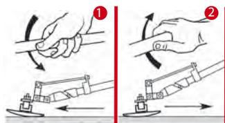
1. Механизм позволяет за счет простого поворота ручки направо изменить направление раздвижного профиля до получения требуемого угла и производить работу по направлению вперед.
